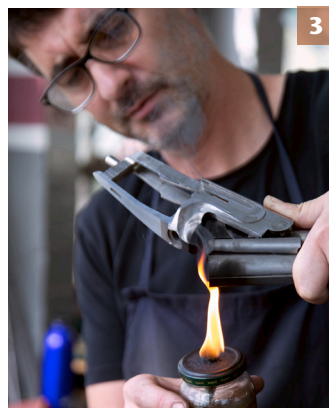
1. L'équipe Arrieta & Arrizabalaga. 2. Le maître crossier Oscar Sánchez sélectionne des bois au fil rigoureusement droit, puis ponce, huile et quadrille à la main. 3. Appliqué dans la bascule, le noir de fumée permet de contrôler l'ajustement à la fermeture avec une précision, de l'ordre du millième de millimètre. 4. Fusil juxtaposé en finition. Entre quinze et quarante couches d'huile sont appliquées selon l'exigence souhaitée. Le bois se pare d'une robe blonde, rousse ou brune aux reflets lumineux.
